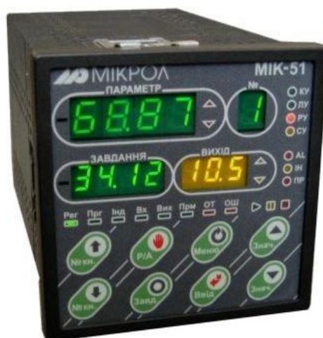
Рисунок 5.2 - Загальний вигляд мікропроцесорного контролера МІК-51
